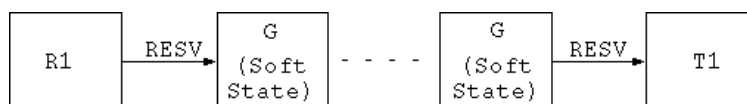
Figura 04- Reserva entre R1 e T1, Criando o Soft State nos Elementos Intermediários.
