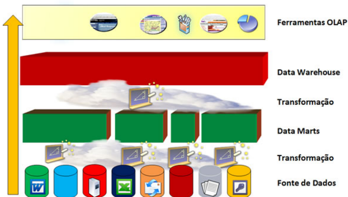
Figura 11 - Arquitetura de um sistema OLAP (www.microsoft.com)
