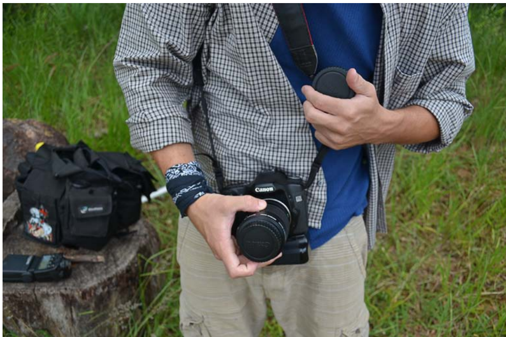
Figura 6: Lente invertida encaixada na câmera, com o auxílio do anel inversor. Fonte: Acervo pessoal.
